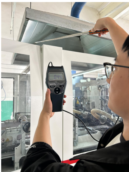
阀口制袋工序集气罩风速（不低于 0.3 米/秒）
