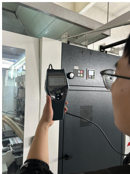
阀口制袋工序集气罩风速（不低于 0.3 米/秒）
